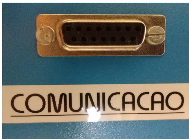
Figura 2.6: Conector de comunicação DB15 presente na bancada
