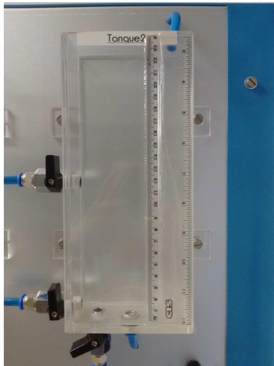
Figura 2.3: Tanque de acrílico
