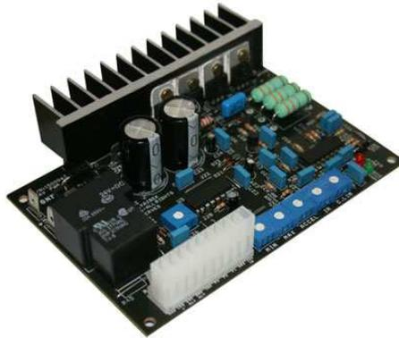
Figura 3.9: Placa de potência atualmente instalada.
