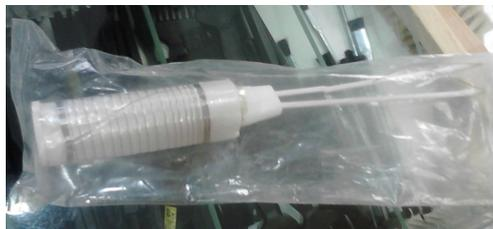
Figura 4.27: Resistência de 500W.
