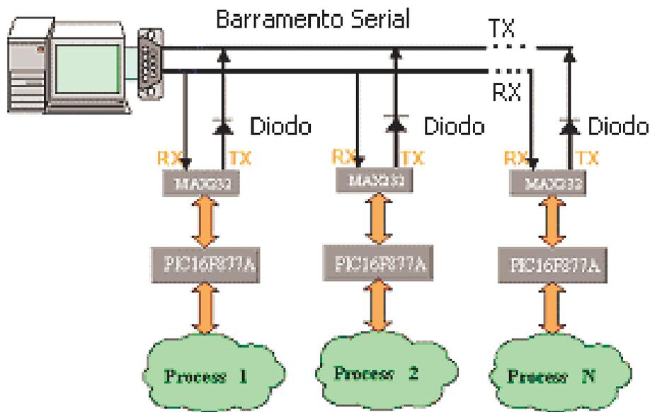
**Figura 5** - Comunicação serial multiponto usando RS232C.
