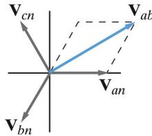
Todas as tensões de linha e tensões de fase (fasores no plano)
