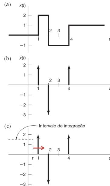
Figura 1.40 (a) Sinal descontinuo  $x(t)$  analisado no Exemplo 1.7; (b) sua derivada  $\dot{x}(t)$ ; (c) representação da reconstrução de  $x(t)$  como integral de  $\dot{x}(t)$ , ilustrada para um valor de  $t$  entre 0 e 1.
